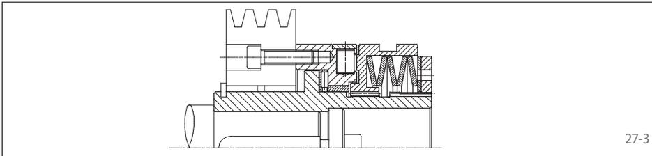
Mit langer Nabe für breite Anbauteile. Lagerung des Anbauteils kundenseitig durch Gleit- oder Wälzlagerung.
