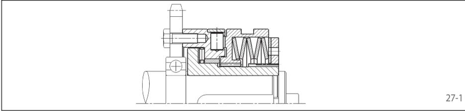
Zum Anbau von Kettenrädern, Riemenscheiben, Zahnrädern usw. Lagerung des Anbauteils auf der Welle durch den Kunden.
