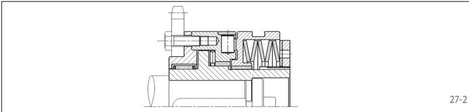
Mit kurzer wälzgelagerter Nabe für schmale Anbauteile.
