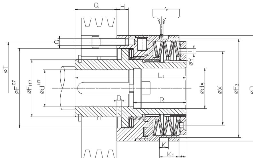
Z = Anzahl der Gewindebohrungen G auf Teilkreis T · Bei Ansprechen des Drehmomentbegrenzers ist die Anlage sofort still zu setzen
