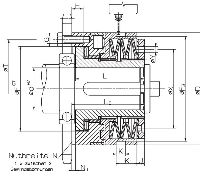
Z = Anzahl der Gewindebohrungen G auf Teilkreis T · Bei Ansprechen des Drehmomentbegrenzers ist die Anlage sofort still zu setzen
