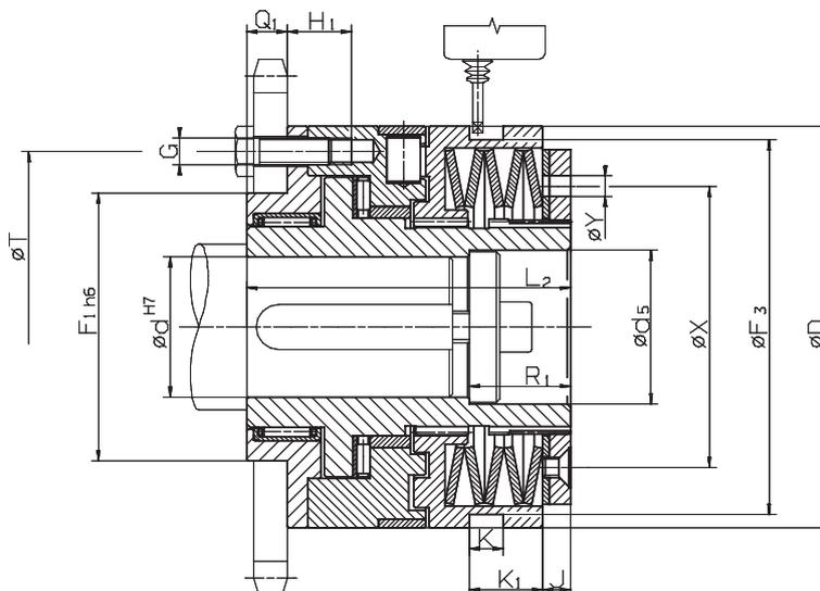
Z = Anzahl der Gewindebohrungen G auf Teilkreis T · Bei Ansprechen des Drehmomentbegrenzers ist die Anlage sofort still zu setzen
